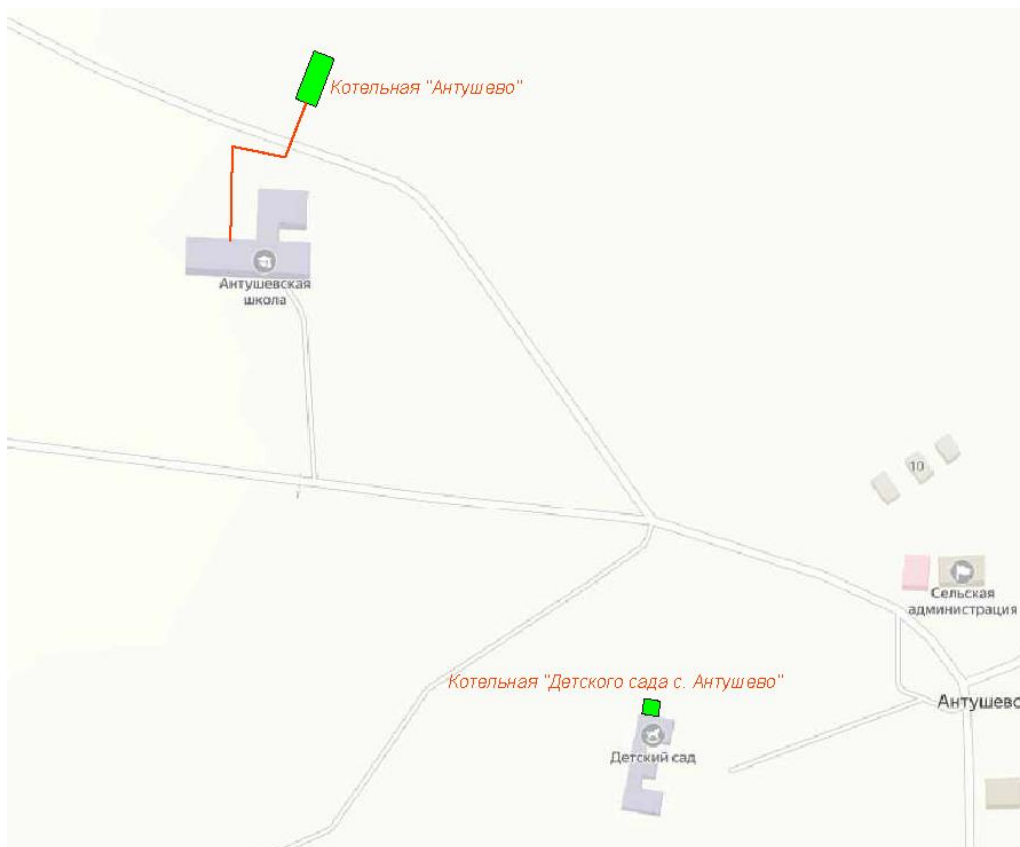
Рис.1.4.9 – Зона действия котельной «Антушево», котельной «Детского сада с. Антушево»
