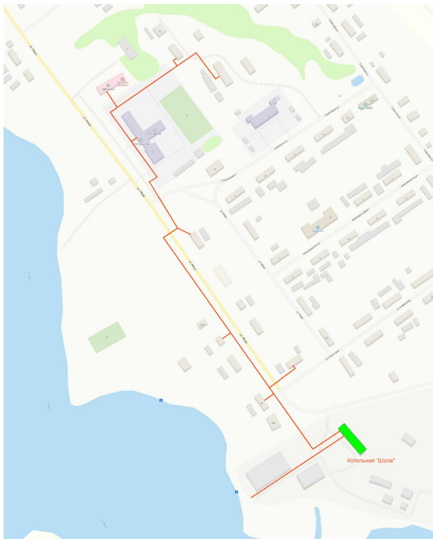
Рис.1.4.11 – Зона действия котельной «Шола»
