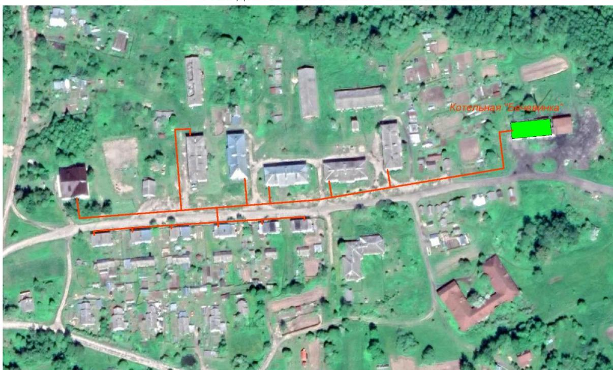
Рис.2.8 – Зона действия котельной «Бечевинка»
