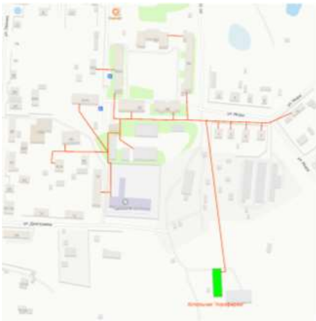
Рис.1.4.2 – Зона действия котельной «Агрофирма»
