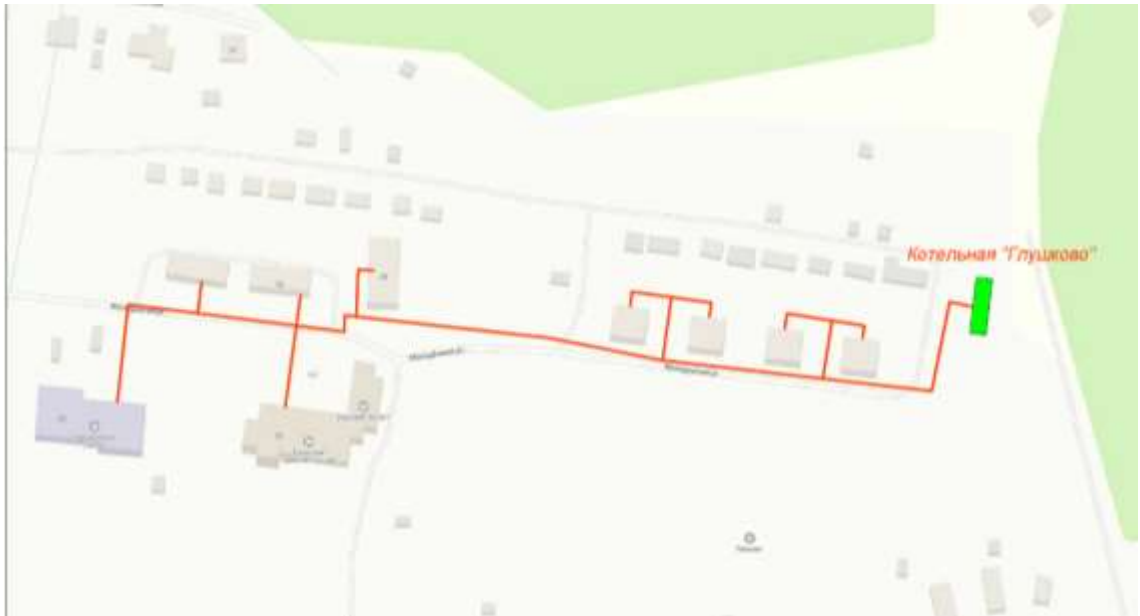
Рис.2.8 – Зона действия котельной «Глушково»
