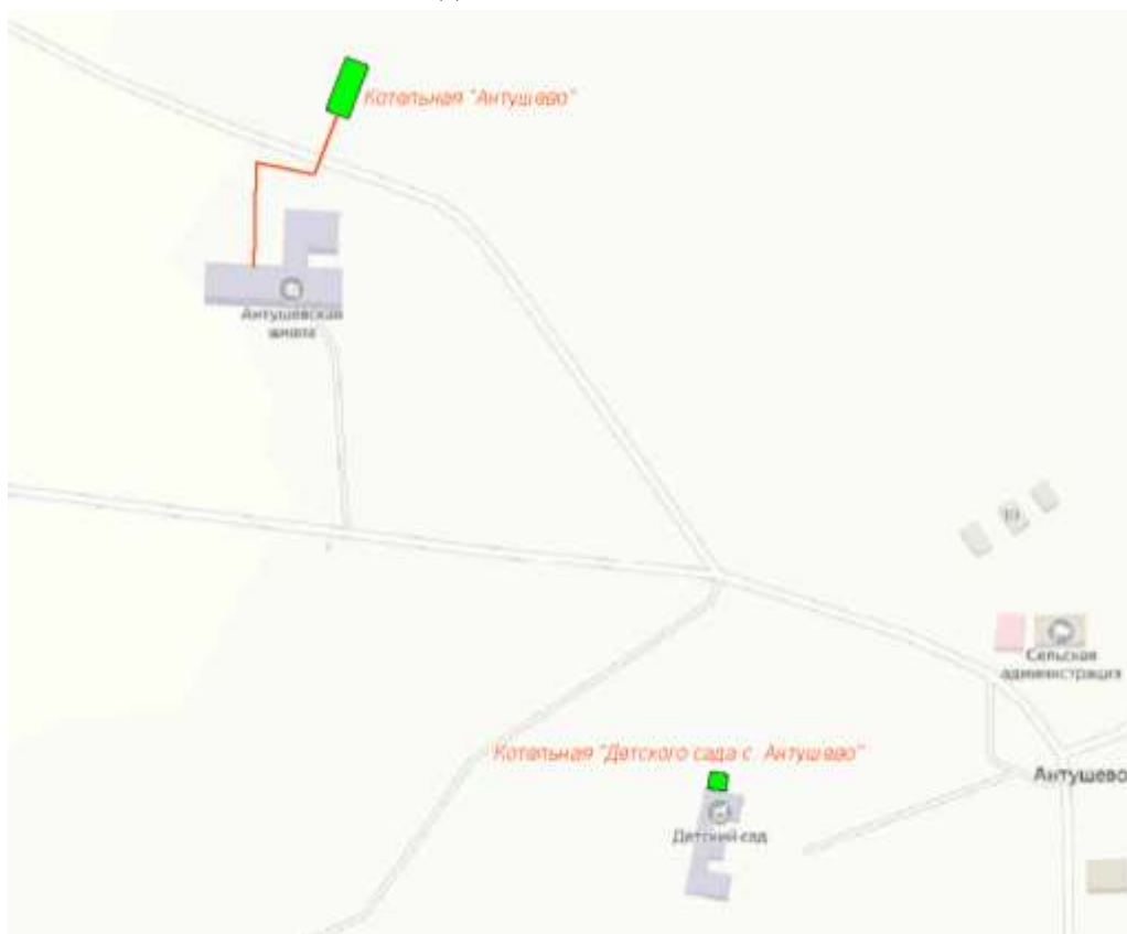
Рис.2.11 – Зона действия котельной «Антушево», котельной «Детского сада с. Антушево»
